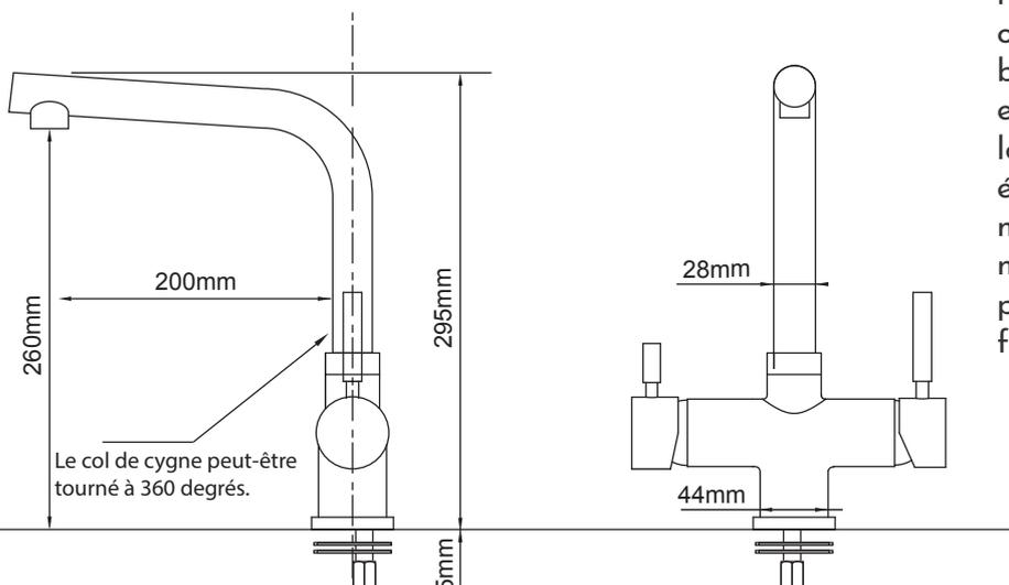
Le robinet est conçu pour fournir de l'eau mitigée ainsi que de l'eau osmosée ou purifiée. Le corps du robinet est en bronze massif, le col de cygne est haut et fabriqué en acier inoxydable, et le robinet est chromé pour un aspect élégant. Le robinet est équipé de deux manettes, l'une pour contrôler l'eau mitigée et l'autre pour l'eau osmosée ou purifiée, et il est pivotant à 360° pour faciliter son utilisation.
