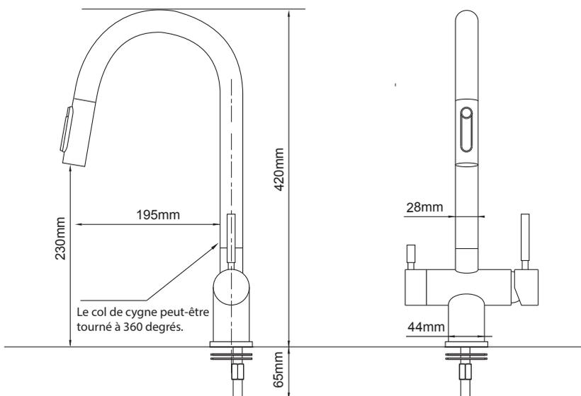
Le robinet est conçu pour fournir de l'eau mitigée ainsi que de l'eau osmosée ou purifiée. Le corps du robinet est en bronze massif, le col de cygne est haut et fabriqué en acier inoxydable, et le robinet est chromé pour un aspect élégant. Le robinet est équipé de deux manettes, l'une pour contrôler l'eau mitigée et l'autre pour l'eau osmosée ou purifiée, et il est pivotant à 360° pour faciliter son utilisation.
