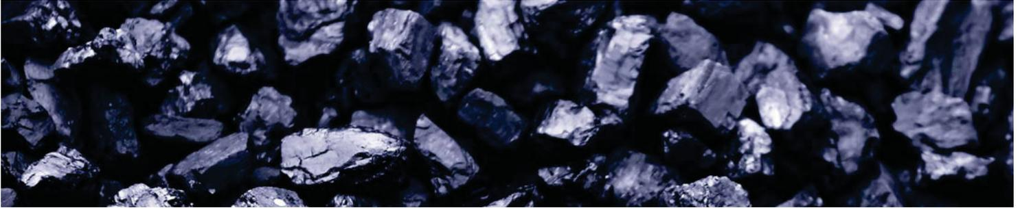
Le Charbon Actif Granulaire (CAG) - ce sont des particules de formes irrégulières parmi une gamme de tailles allant de 0.2 mm à 5 mm. Ce type de charbon est utilisé pour des applications en phase liquide et gazeuse.
