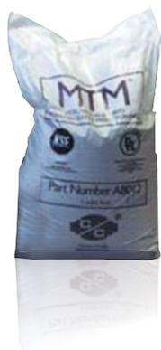
Le MTM est composé d'un noyau granulaire léger revêtu de bioxyde de manganèse. Il est utilisé pour la réduction de fer, le manganèse et hydrogène sulfuré se trouvant dans l'eau. Son revêtement superficiel acide oxyde et précipite le fer et le manganèse, tandis que le sulfure d'hydrogène est oxydé à soufre.
