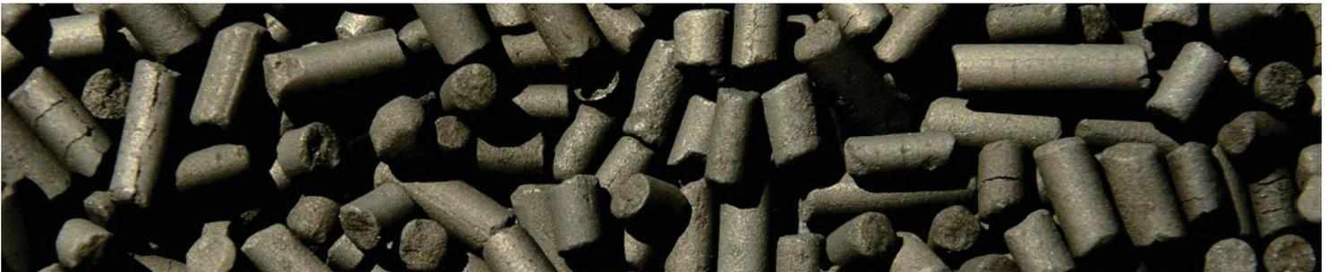
Le Charbon Actif Extrudé - de formes cylindriques avec des diamètres allant de 0.8 mm à 5 mm. Le charbon Actif extrudé est principalement utilisé pour des applications en phase gazeuse à cause de sa faible perte de charge, de sa grande résistance mécanique et de sa faible teneur en poussières.
