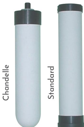
La céramique: l'ensemble des porte filtres standards et les porte-filtres bougie est constituée de terre de diatomée. Elle forme un filtre de haute densité d'une finesse de filtration inférieure à 0,2µm.
