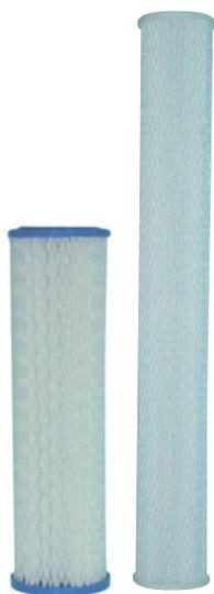
Nos cartouches plissées, lavables, sont utilisées pour la filtration en surface du sable, de la rouille et des sédiments. Pour un usage domestique, elles servent notamment à la filtration de l'eau de boisson, la protection de votre robinetterie, de votre chaudière, de votre machine à laver et de toutes autres installations.
